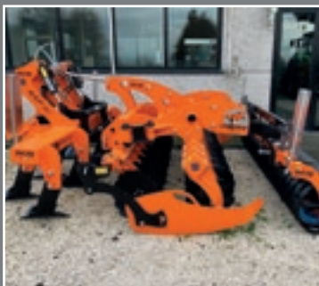
Erpice a dischi MA-AG VORTEX 30 P tre metri di lavoro, rullo ad anelli, bandelle di contenimento laterali e barra luci. Possibilità di agganciare anteriormente all'erpice un decompattatore con ancore Michel H600 per lavorare in profondità!
